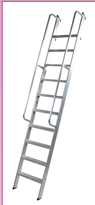
ART. 278 SCALA DA APPOGGIO Montanti da mm 78x22, gradini rigati antiscivolo da mm 80, larghezza cm 40, piedini antiscivolo in gomma, applicazioni di ganci, ruote a richiesta.
