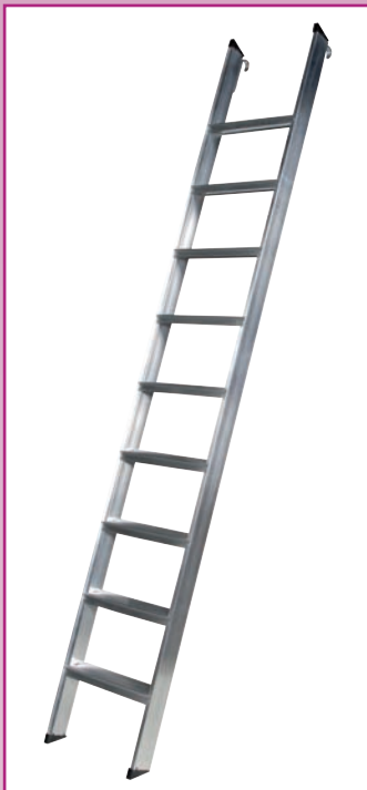
ART. 278 SCALA DA APPOGGIO Montanti da mm 78x22, gradini rigati antiscivolo da mm 80, larghezza cm 40, piedini antiscivolo in gomma, applicazioni di ganci, ruote a richiesta.
