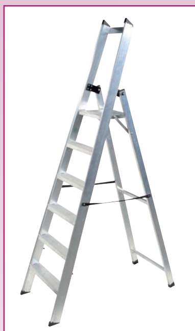
ART. 230 SCALA A CASTELLO PIEGHEVOLE Struttura in trafilato rettangolare in duralluminio e mancorrenzi in tubo tondo, gradini rigati antiscivolo da mm 150 inclinazione 60°, ripiano in lastra mandorlata, 2 ruote da \varnothing 125, piedini in gomma antiscivolo.
