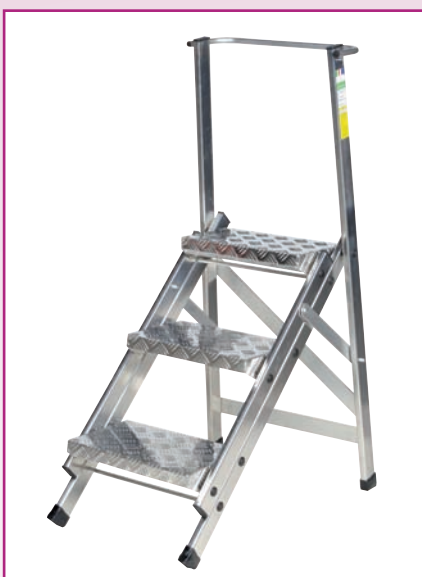
ART. 330 SGABELLO PIEGHEVOLE IN ALLUMINIO Struttura in tubo 50x20, gradini in lastra mandorlata mm 230x260, piedini in gomma antiscivolo. Nella foto ART 330/MAN Con maniglione ad H 50 dal piano
